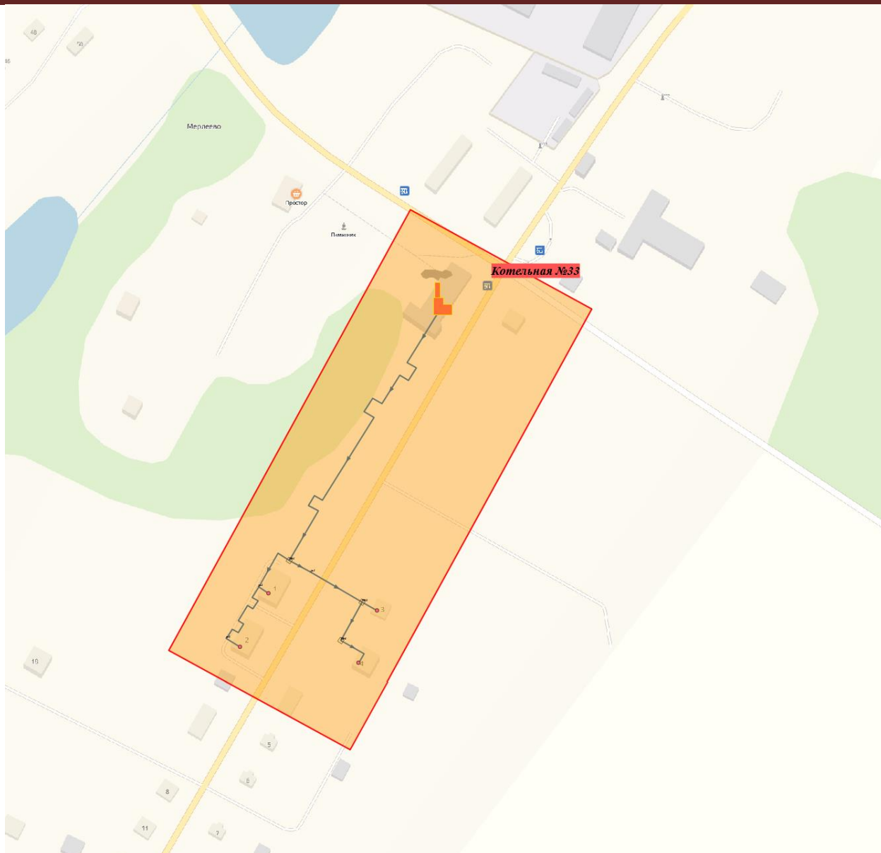
Рис. 3.1.2.3.27. - Зона действия котельной №33
